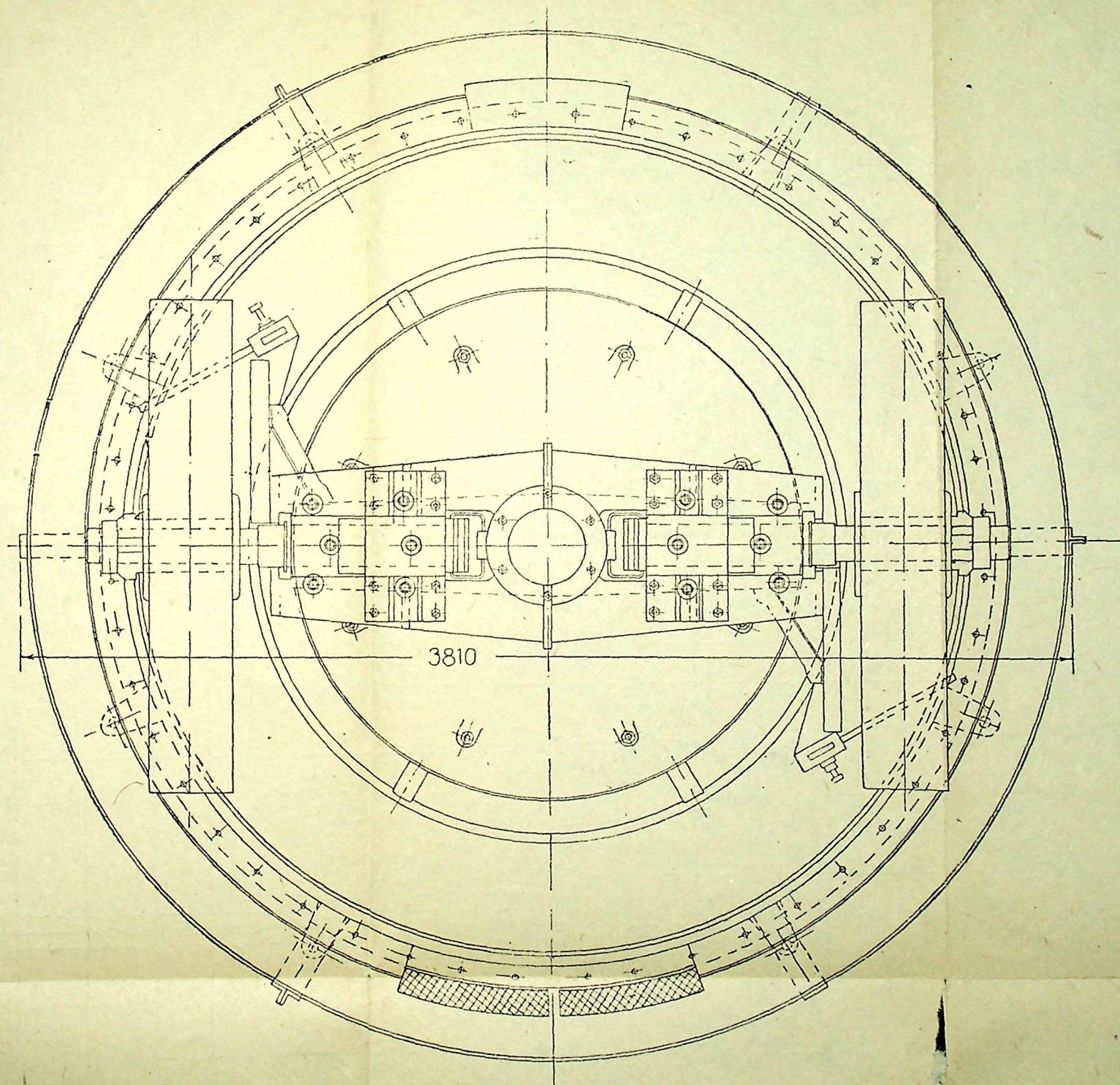
Рис. 21. Бегунная чаша типа Бейльдона современной конструкции.
